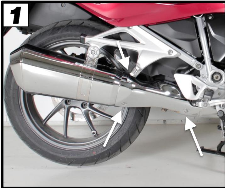
Lösen Sie die Schrauben des Halters und der Schelle. Anschließend entfernen Sie den originalen Schalldämpfer. (Abb.2)
