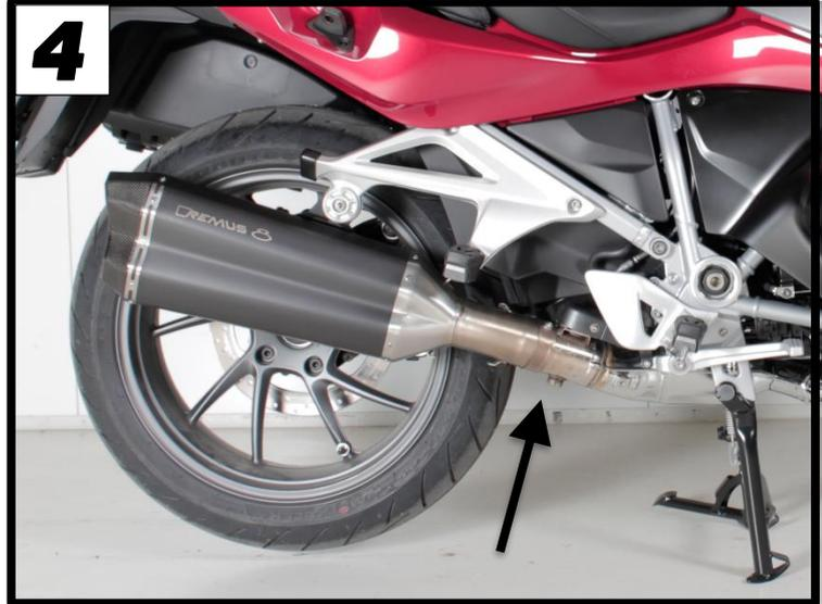
Montieren Sie die Federn sowie die REMUS Hitzeschutzabdeckung mit den mitgelieferten Schrauben. Zur Positionierung der Hitzeschutzabdeckung drehen Sie die am Verbindungsrohr montierte Schelle in die gewünschte Position. Der Abstand zwischen Hitzeschutz und Klappengehäuseabdeckung sollte gleichmäßig sein. Positionieren Sie den Schalldämpfer und ziehen alle Schrauben fest (Abb. 5 / 6).
